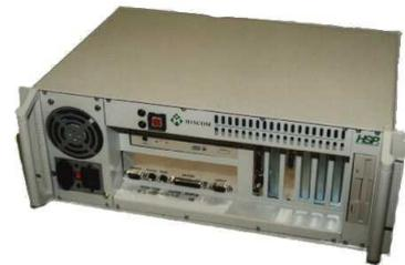
Der Aufbau der Hardware erfolgte im Hardware-Labor der Firma Abele Informatik. Anschliessend wurden grundlegende Prüfungen wie ein ausgiebiger Speichertest (mit dem Programm „memtest86“) und ein Dauer-Belastungstest durchgeführt.
