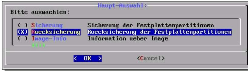
Der Menüpunkt "**Sicherung**" listet alle Partitionen der erkannten Festplatten auf und fragt nach einem Namen der Sicherung und den einzubeziehenden Partitionen.
